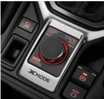
בלם חנייה חשמלי כולל מערכת Auto Vehicle Hold
